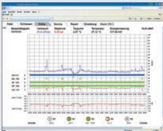
Alle Daten werden in hoher Auflösung (1x/Sek.) berechnet und in Diagrammen übersichtlich dargestellt – für eine präzise Beurteilung der gesamten Druckluftstation.
